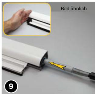
Lager rechts wie abgebildet in die Netzelle im Rollläusen einschieben (achten Sie auf die Einkerbungen am Lager/der Rücklaufbremse!). Halten Sie auf der anderen Seite dagegen, damit die Netzelle dabei nicht herausgeschoben wird.
