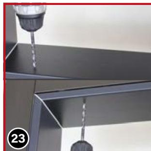
Bohren Sie an den markierten Stellen je ein Loch Ø6 mm und stecken Sie die mitgelieferten Universal-Dübel ein.
