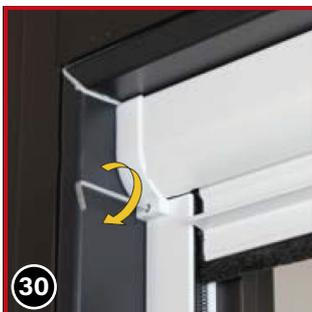
Für eine zusätzliche Befestigung können Sie die Endkappen mit einer Madenschraube (7) von vorne am Rollokasten mittels Sechskantschlüssel (50) fixieren. Sie können diesen Schritt auch überspringen, wenn der Kasten oben am Fenstersturz anliegt.
