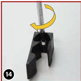
14 Schrauben Sie je eine Madenschraube (7) mit dem Sechskantschlüssel (50) von innen in die Sockel. Nur so weit, dass die Spitze des Kopfs der Madenschraube auf der glatten Seite des Sockels (5) fast raus schaut.
