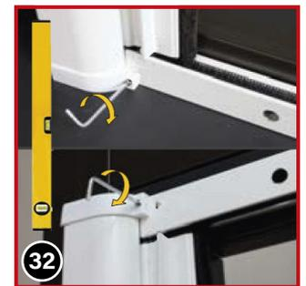
Nun die Madenschrauben (7) von vorne mit dem Sechskantschlüssel (50) in die Endkappen (10) eindrehen – nur so weit schrauben, bis Sie einen Widerstand spüren!
