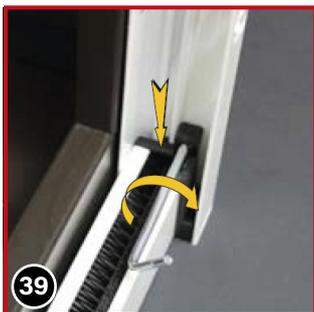
39 Schieben Sie den oberen Führungsstopper (22) auf die Führungsschiene auf. So weit, bis dieser hinter der Führungsschiene verschwindet und diese mit seinem Haken fixiert.
